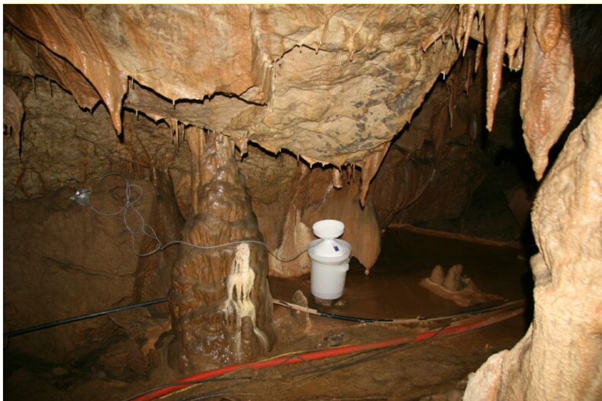
Slika 4: Vzorčno mesto 8; na vzorčevalniku je nameščen ombrometer, levo na steni je datalogger.
