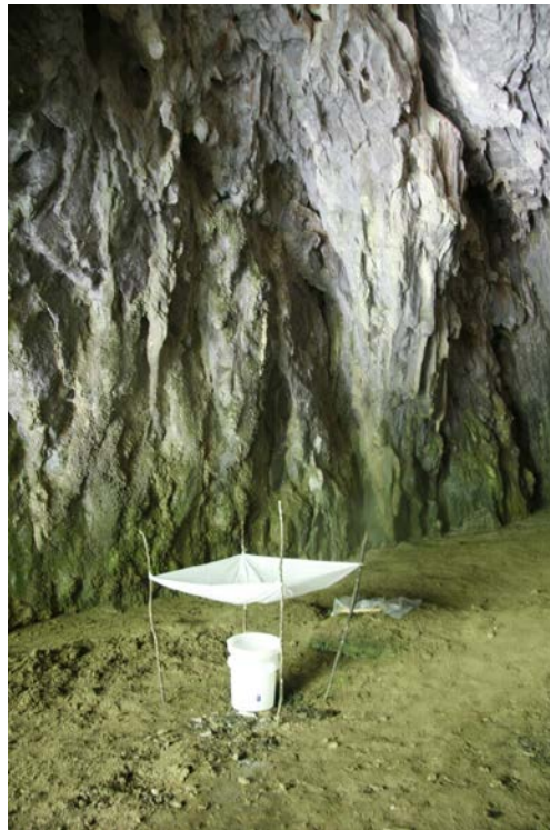
Slika 7: Vzorčevalno mesto 2 v Brihti jami; ponjava poveča površino zbiranja kapnice.
